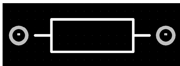
Рисунок 5.5 — Создание посадочного места постоянного резистора
