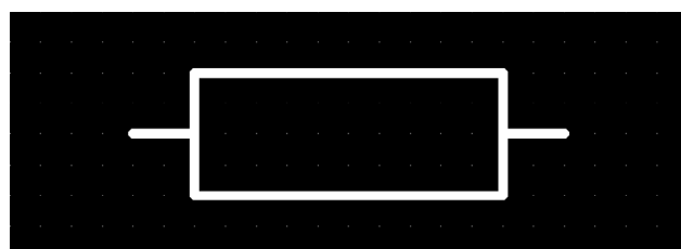
Рисунок 5.5 — Создание посадочного места постоянного резистора
