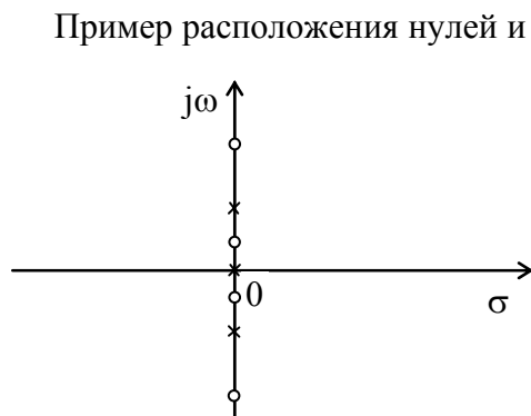
Рис. 3.2 — Расположение нулей и полюсов реактивного сопротивления
