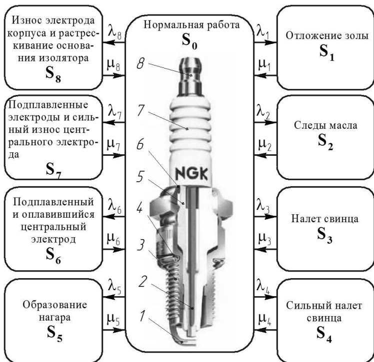
Рисунок 7.3 – Граф состояний свечи зажигания с учетом отказов её элементов: 1 – боковой электрод; 2 – центральный электрод с медным стержнем; 3 – резьба; 4 – уплотнительное кольцо; 5 – изолятор; 6 – кольца прокладки; 7 – гофрированный цоколь; 8 – контактная головка
