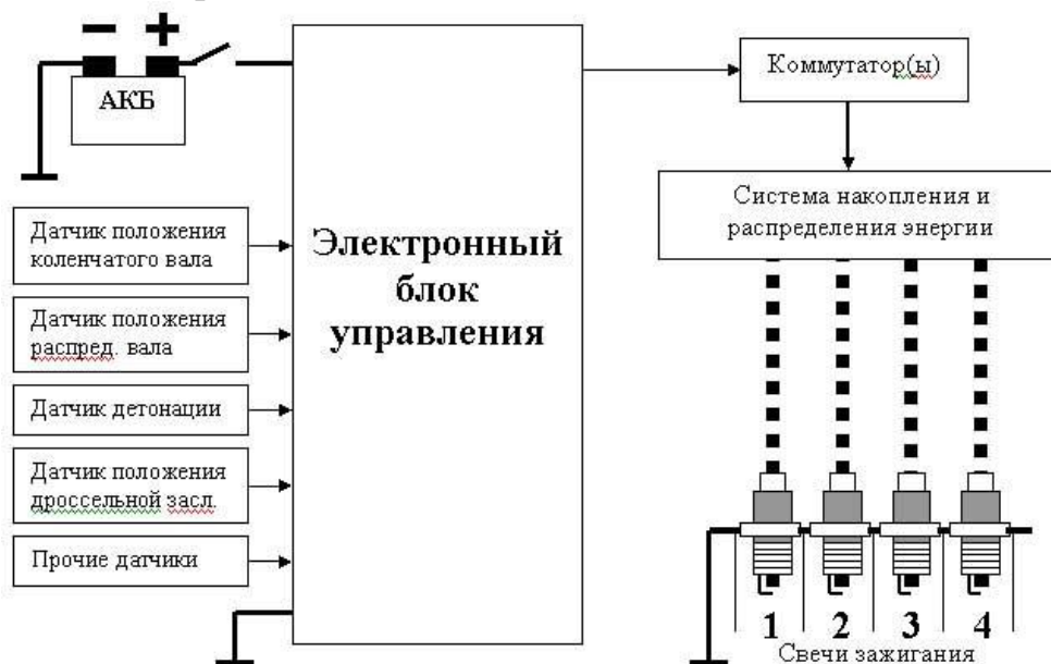
Рисунок 1.3 – Схема микропроцессорной системы зажигания
