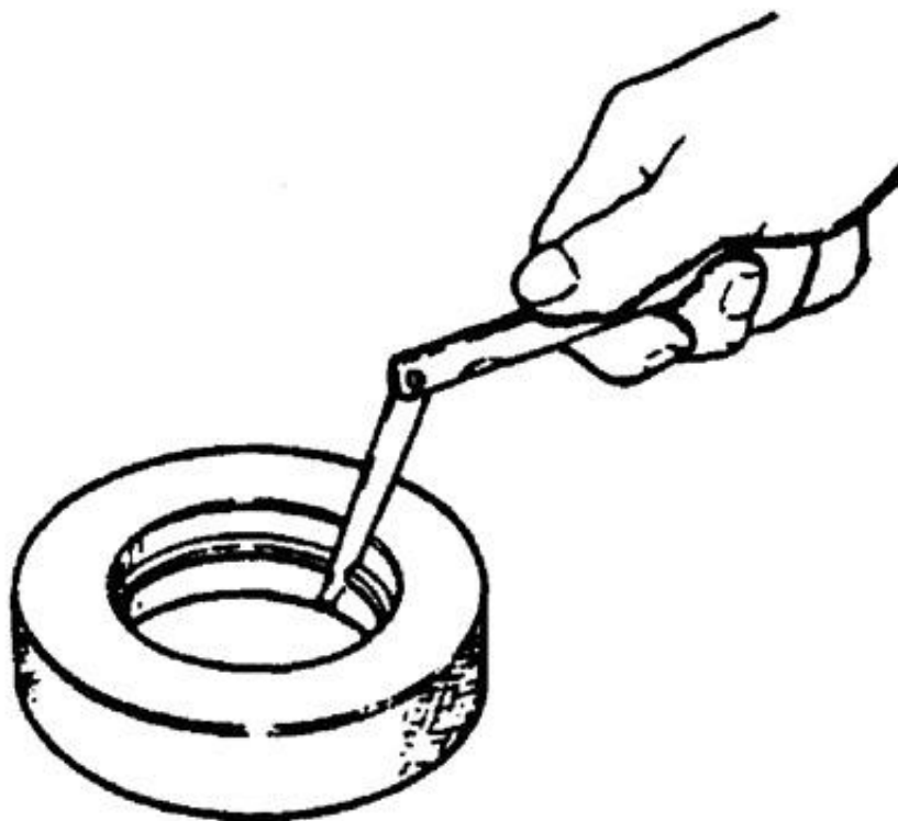
Рисунок 3.2 – Проверка зазора между поршневыми кольцами и канавками
