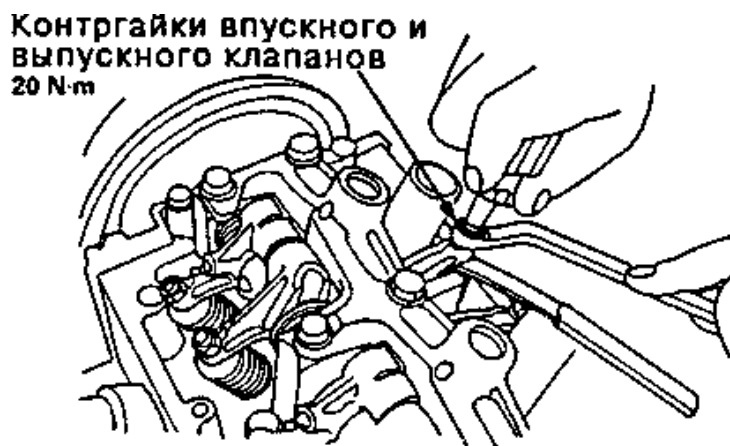
Рисунок 5.4 – Затяжка контргаек регулировочных винтов коромысел впускных и выпускных клапанов
