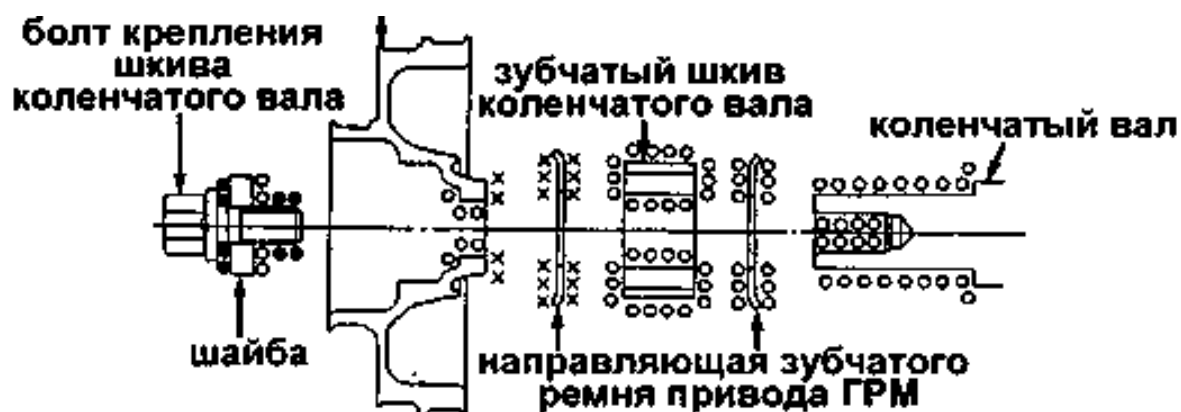
Рисунок 5.8 – Карта смазки шкива коленчатого вала: О – очистить; х – удалить масло; • – смазать.
