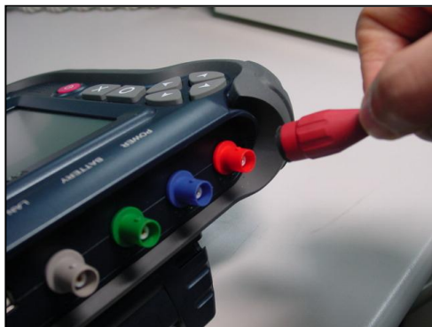
Рисунок 1.11 – Метод подсоединения кабеля осциллографа 1
