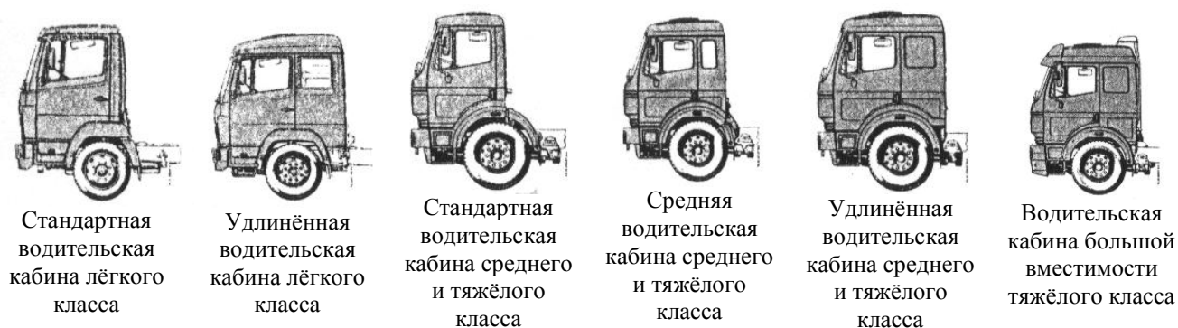
Рисунок 4.3 – Компоновка кабин грузовиков «Мерседес-Бенц»
