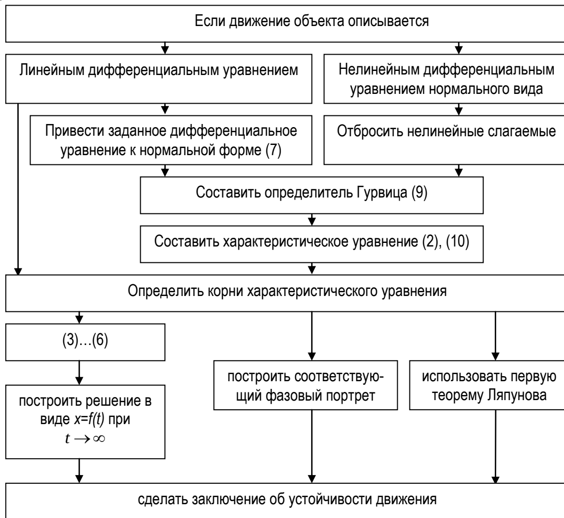
Рисунок 1 – Методы прямого интегрирования дифференциальных уравнений, фазовых координат, исследования по первой теореме Ляпунова и по первому приближению
