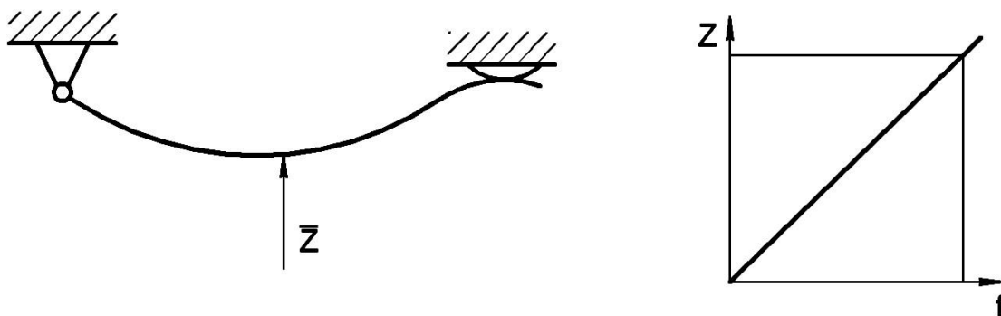
Рисунок 2.2 – Кинематическая схема и характеристика одинарного стального упругого элемента
