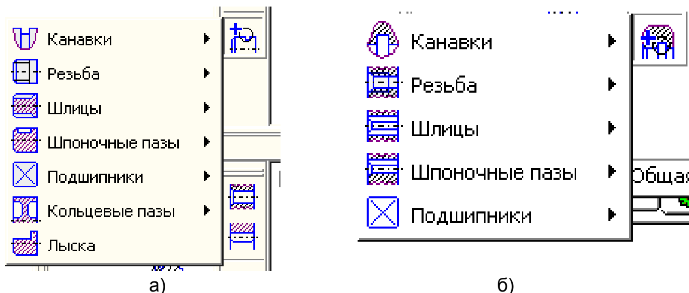
Рисунок 2.5 — Дополнительные элементы цилиндрического элемента наружного (а) и внутреннего (б) контура
