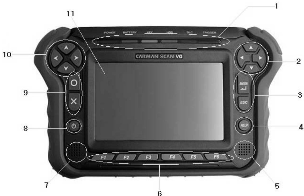
Рисунок 8.2 – Передняя панель прибора CARMAN SCAN VG 1 – статус дисплея LED; 2 – кнопки направления; 3 – ENTER/ESC; 4 – HELP; 5,7 – динамики; 6 – специальные кнопки; 8 – кнопка питания; 9 – включение/выключение; 10 – кнопки направления; 11 – LCD
