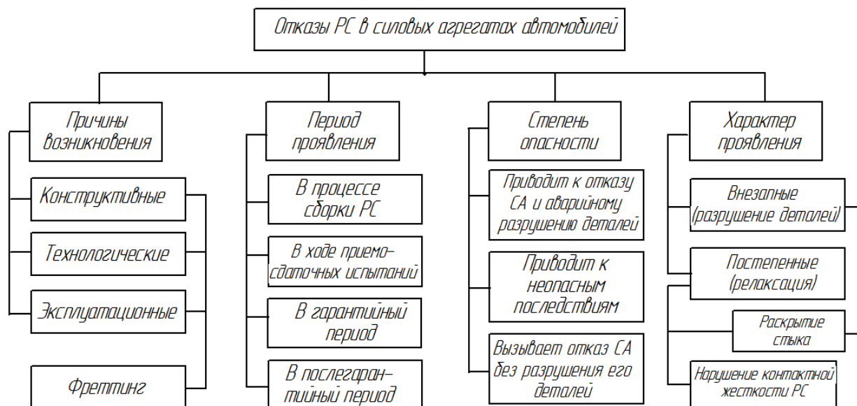
Рисунок 1 — Классификация отказов резьбовых соединений в САА
