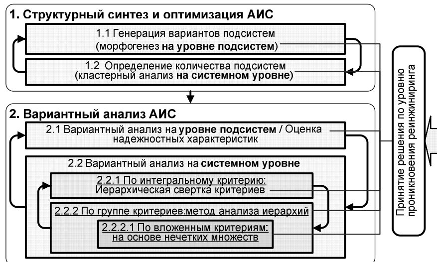
Рисунок 1 — Общая схема построения и совершенствования АИС: два основных этапа построения системы (структурный синтез, включающий оптимизация и вариантный анализ); их составляющие: морфологический и кластерный анализ, вариантной анализ на подсистемном и системном уровнях по интегральному и вложенным критериям
