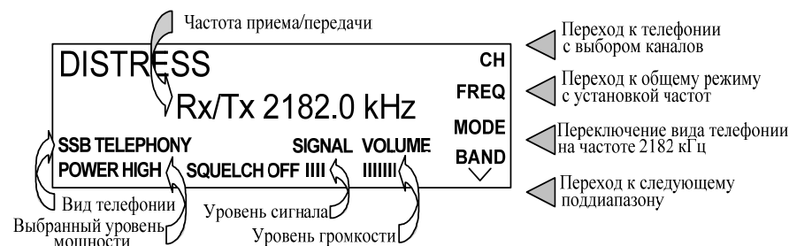
Рис. 3.1.3 — Вид экрана радиоустановки в режиме телефонии на частотах бедствия, срочности, безопасности
