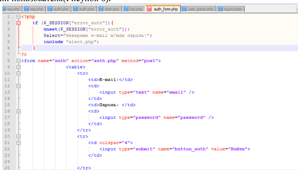
Рисунок 6. Форма авторизации пользователя с предварительной проверкой авторизации пользователя.
