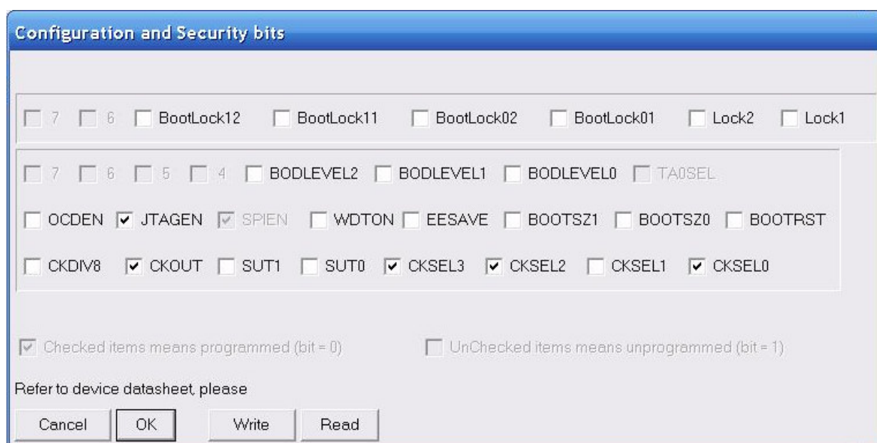
Рисунок 3.4 – Значения FuseBits для 8МГц
