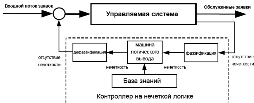
Рисунок 1 –Функциональная схема системы нечеткого управления
