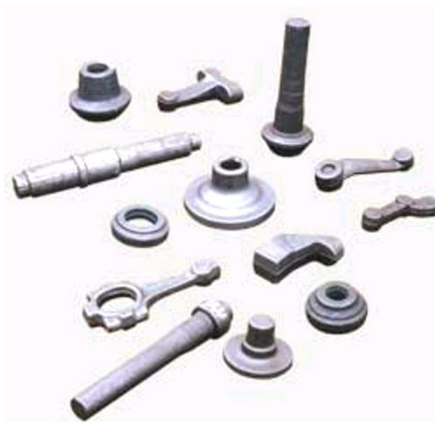
Рисунок 2 — Кованные и штампованные заготовки
