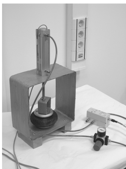
Рисунок 6 — Экспериментальный стенд системы позиционирования
