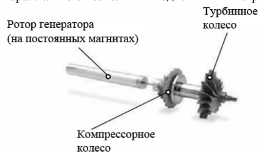
Рисунок 3 – Вал микротурбины фирмы Capstone
