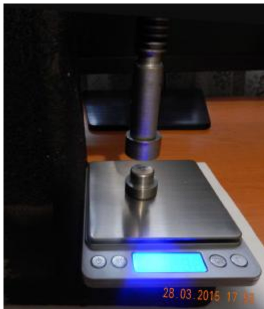
Рис. 5. Установка для раздавливания зерен ИОС
