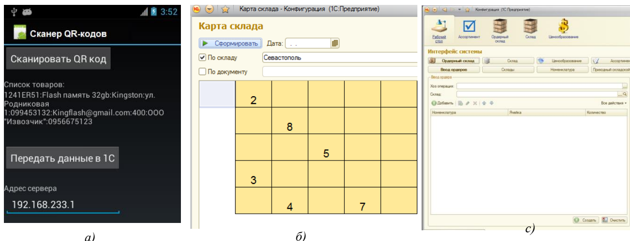
Рис.1. Элементы интерфейса системы автоматизации складского учета (а –мобильное приложение; б – карта склада; в –рабочий стол пользователя)
