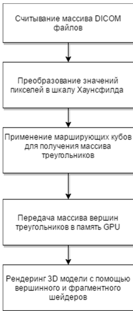
Рис 1. Структурная схема построения 3D модели по данным DICOM файлов.
