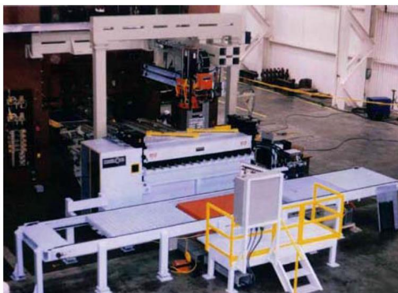
Рисунок 9: Устройство для расстыковки листов
