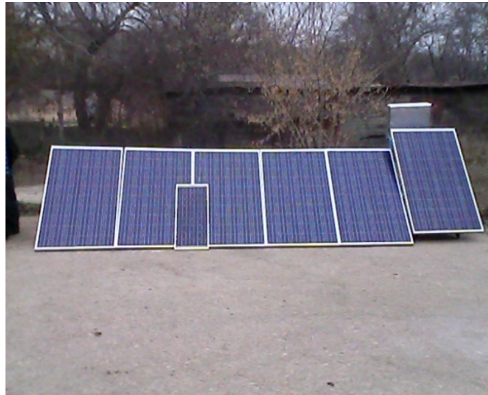
Рисунок 1 – Лабораторная установка мощностью 1,5 кВт, состоящая из 6 модулей RS-250 и дополнительного модуля для измерений ISM-50
