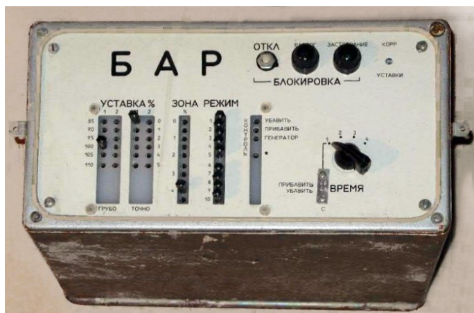
Рис. 1 - Внешний вид блока автоматического регулирования напряжения трансформатора (БАР).
