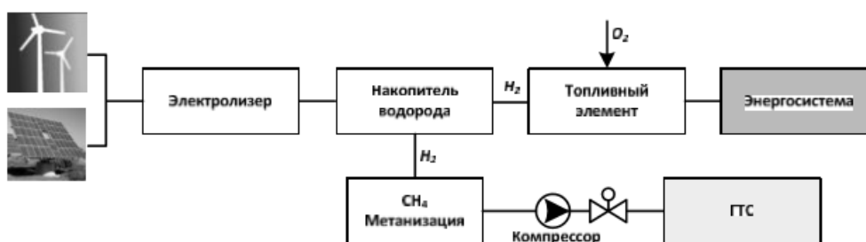
Рисунок 4 - Структурная схема получения и преобразования водорода.
