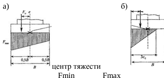
Рисунок 6 - Схема для определения давления под подошвой фундамента: а) при малых эксцентриситетах e < B/6 ; б) при больших эксцентриситетах e > B/6
