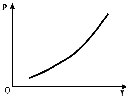
Рисунок 5 — График зависимости удельного сопротивления металла от температуры
