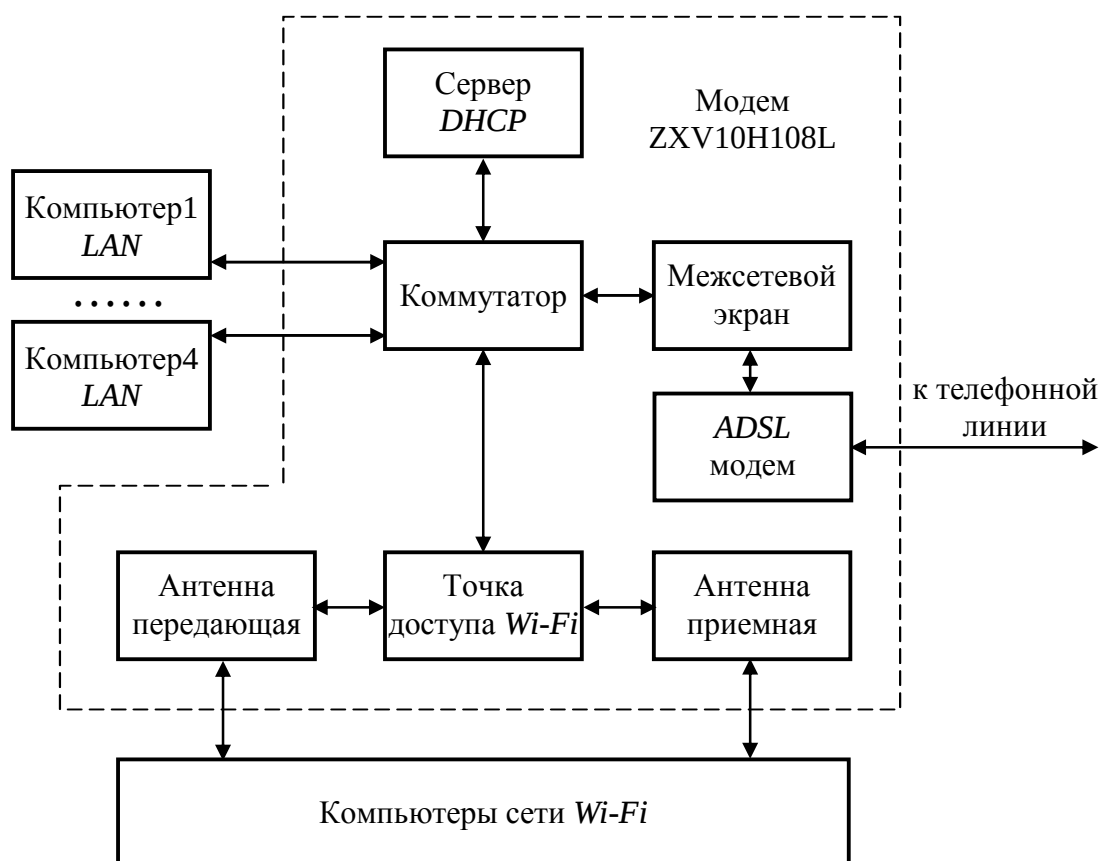
Рис. 2.2 — Структурная схема беспроводного ADSL модема ZXV10H108L
