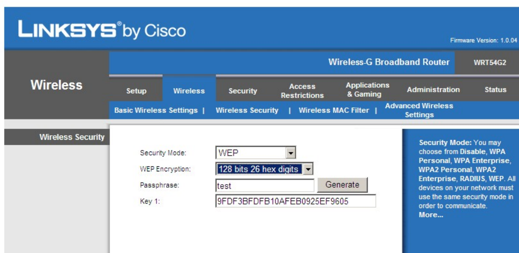
Рис. 1.12 — Вид окна установки параметров защиты беспроводной сети в режиме WEP
