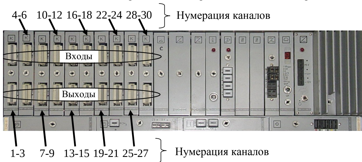
Рис. 1.5 — Схема расположения разъемов на передней панели БЧПКПР
