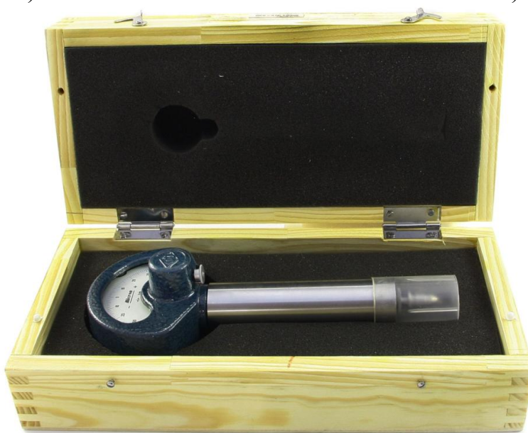
Рисунок 7.3 – Внешний вид головки измерительной (микрокатора) 1ИГП: а) с защитным колпаком; б) без защитного колпака; в) в футляре
