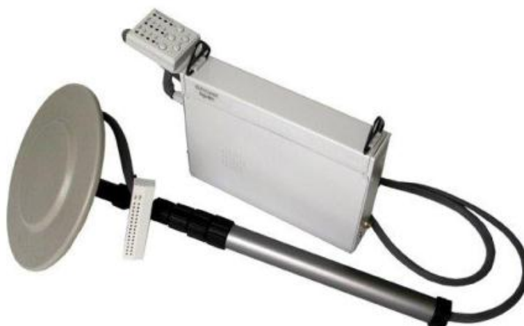
Рис. 3.2. Общий вид нелинейного локатора «Катран»
