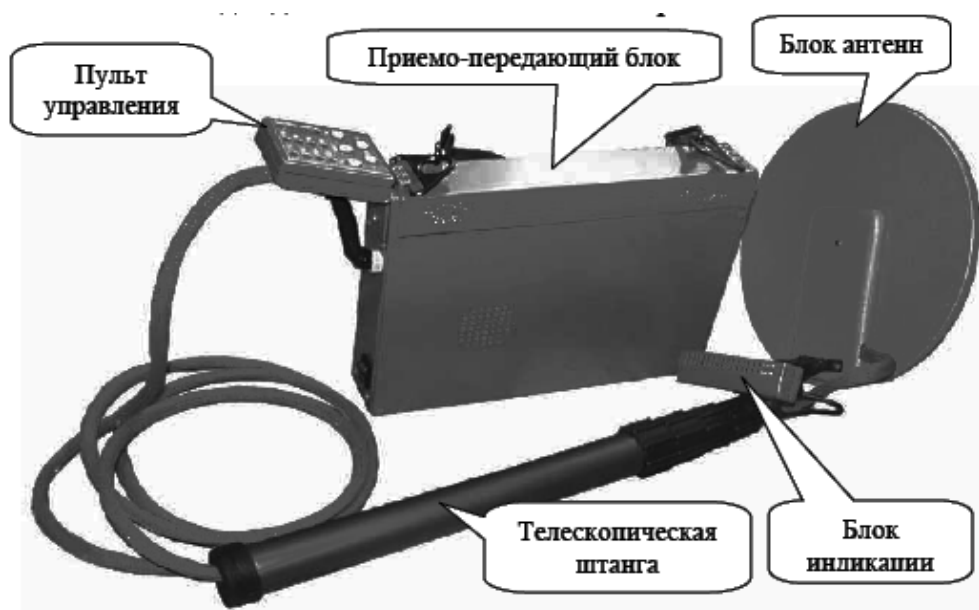
Рис. 3.3. Состав нелинейного локатора «Катран»
