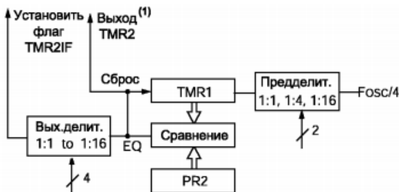
Рис. 5.6. Структурная схема модуля TMR2
