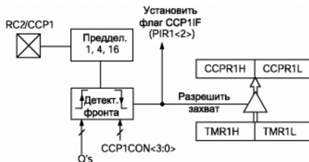
Рис. 5.2. Структурная схема модуля CCP2 в режиме захвата
