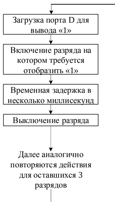
Рис. 2.3. Фрагмент алгоритма для реализации динамической индикации
