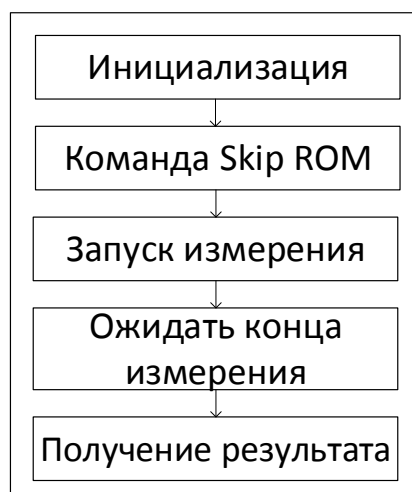
Рис.7.5. Алгоритм взаимодействия с датчиком для считывания температуры
