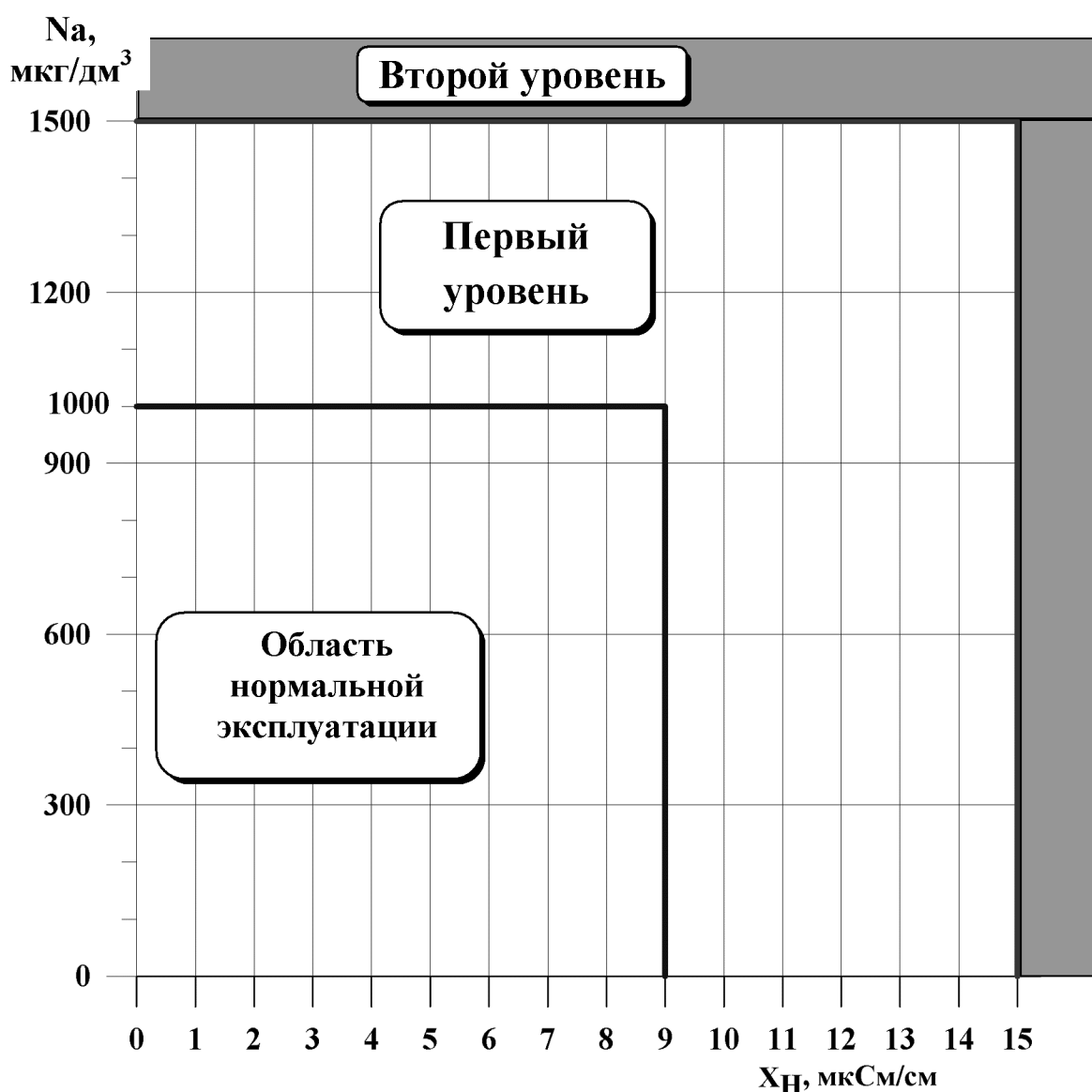
Рис. 4.18. Ограничения по эксплуатации энергоблока при работе на мощности менее 50 % от номинальной при отклонении нормируемых показателей качества продувочной воды ПГ от допустимых значений
