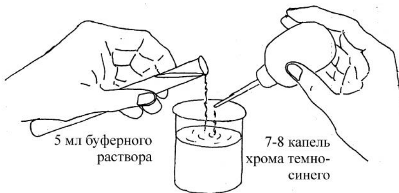
Рис. 4.2. К определению общей жесткости воды. Фаза 1
