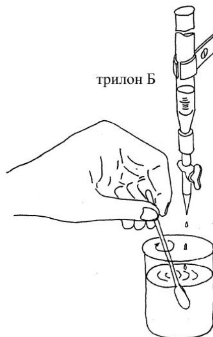
Рис. 4.3. К определению общей жесткости воды. Фаза 2
