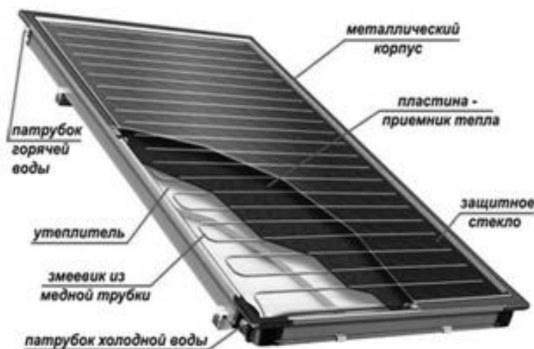
Рис. 4.1. Конструкция плоского солнечного коллектора
