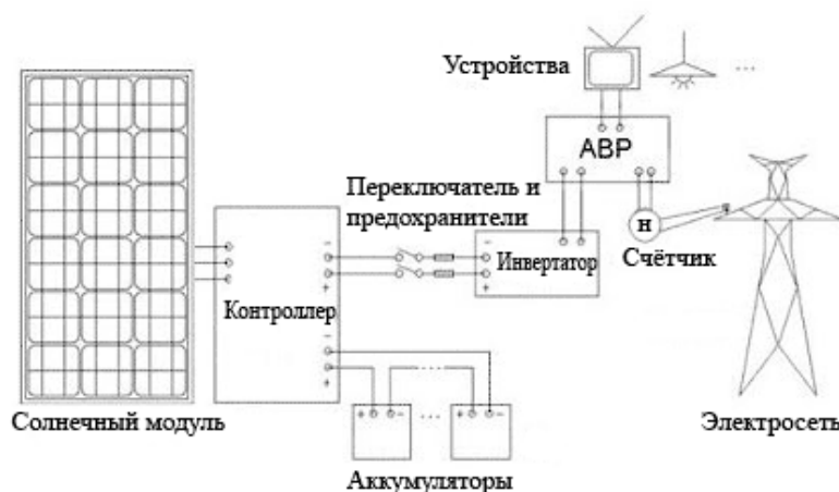
Рис. 4.5. Фотоэлектрическая электростанция с аккумуляторами, соединенная с сетью
