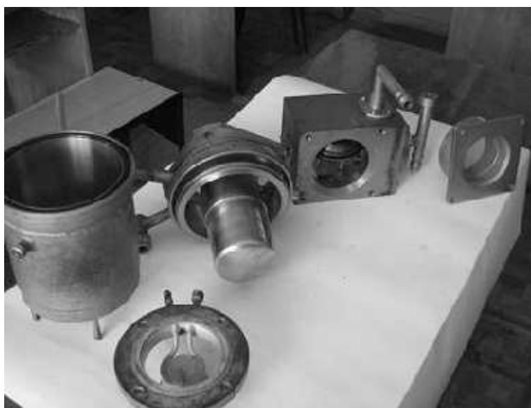
Рис. 15. Детали вакуумного поста в разобранном виде на стенде вакуумного поста
