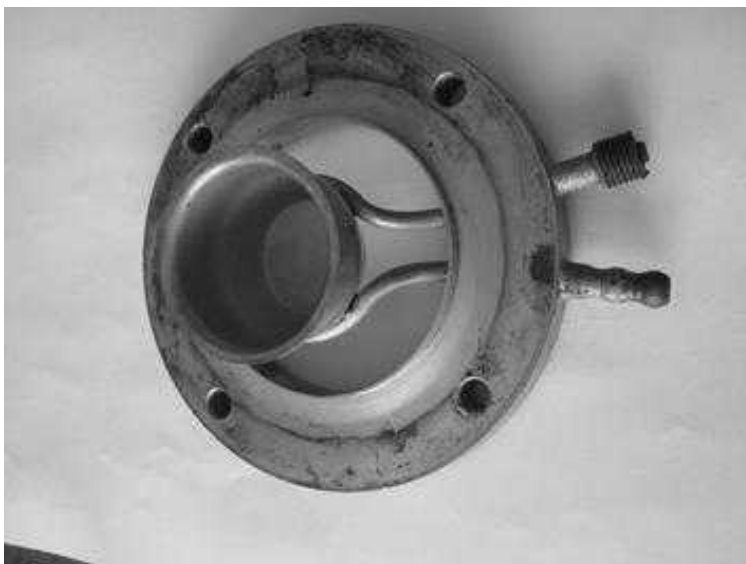
Рис. 7. Маслоотражающая пластина с водяным охлаждением
