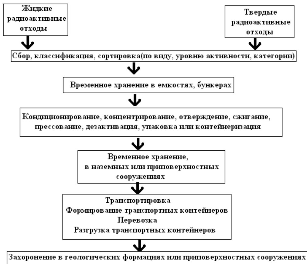
Рис. 1. Принципиальная схема обращения с РАО
