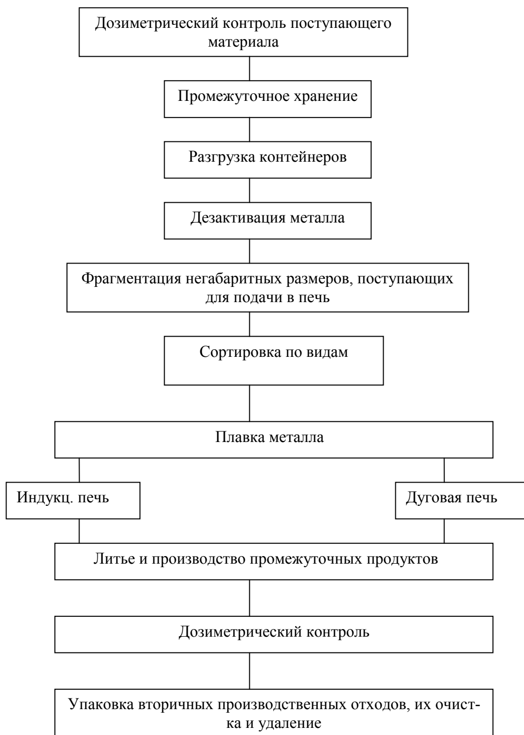
Рис. 23. Технологическая схема процесса переплавки (фирма SIEMPELKAMP)
