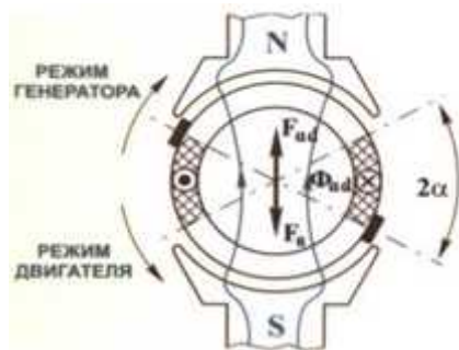
Рис. 6. Возникновение продольной МДС якоря при сдвиге щеток с геометрической нейтральной
