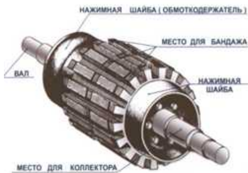
Рис. 7. Сердечник якоря без обмотки
