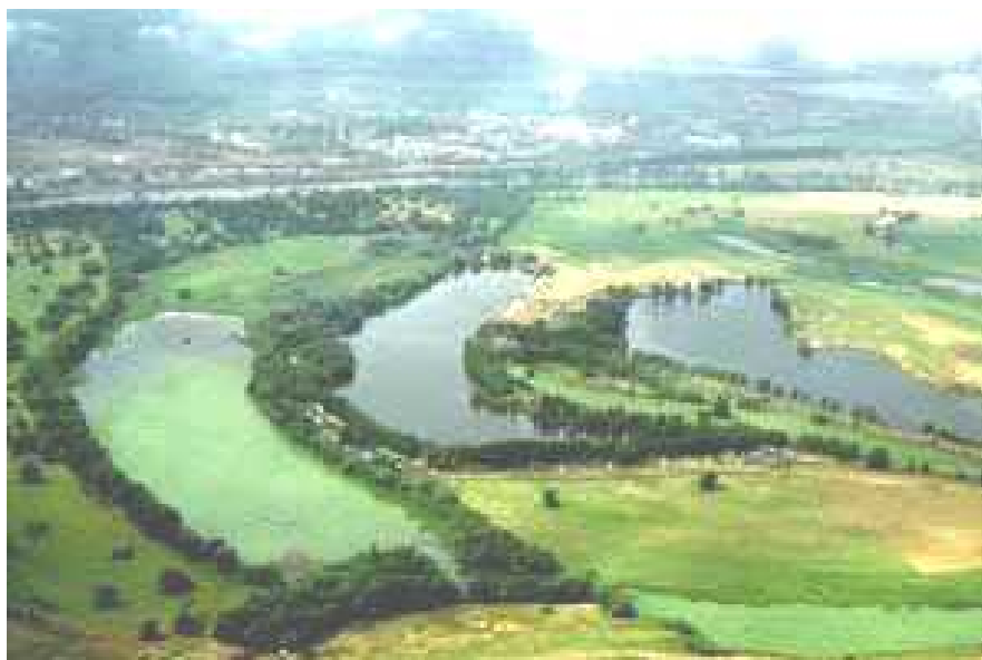
Рис. 7.1. Система прудов позволяет аккумулировать часть поверхностного стока, что приводит к снижению максимальных затоплений
