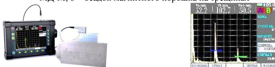
Рис. 2. Ультразвуковая дефектовка: а – ультразвуковой дефектоскоп мод. NOVOTEST УД-1; б – сигнал на экране в виде А- и В-сканов
