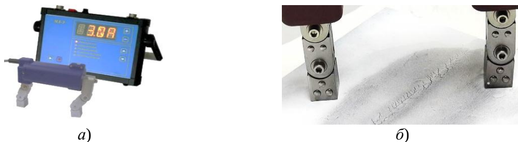
Рис. 1. Магнитопорошковая дефектовка: а – магнитопорошковый дефектоскоп мод. МД-М; б – осадок магнитного порошка на трещинах
