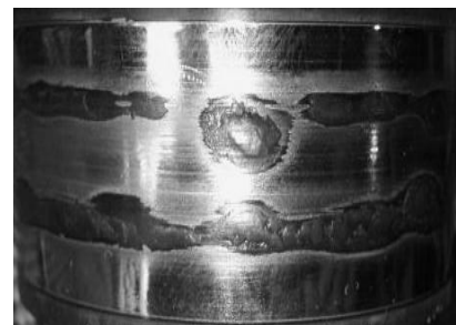
Рис. 2. Износ рабочих поверхностей шкивов: а – клиноременной передачи; б – передачи зубчатым ремнем; в – плоскоременной передачи
