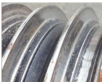
Рис. 2. Износ рабочих поверхностей шкивов: а – клиноременной передачи; б – передачи зубчатым ремнем; в – плоскоременной передачи
