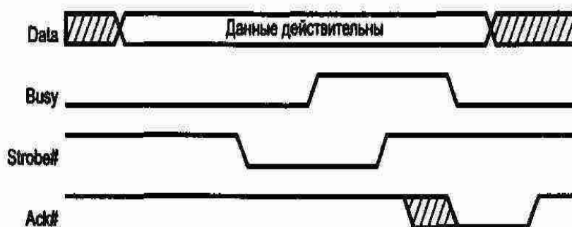
Рисунок 2.1 — Диаграмма работы по протоколу Centronics
