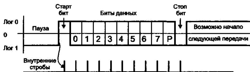
Рисунок 3.1 — Формат асинхронной передачи
