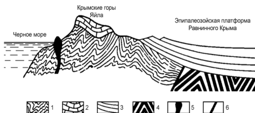
Рис. 20. Схематический геологический разрез Крымского полуострова в меридиональном направлении (по А.А.Богданову):
