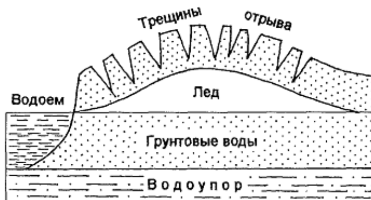
Рис. 8. Строение гидролакколита (по А.А. Махнач, А.В. Матвееву), http://www.geoversum.by
