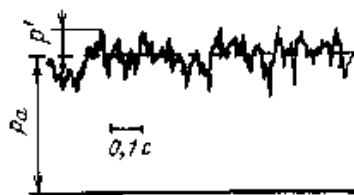
Рис. 6.2. Пульсация давления в турбулентном потоке.
