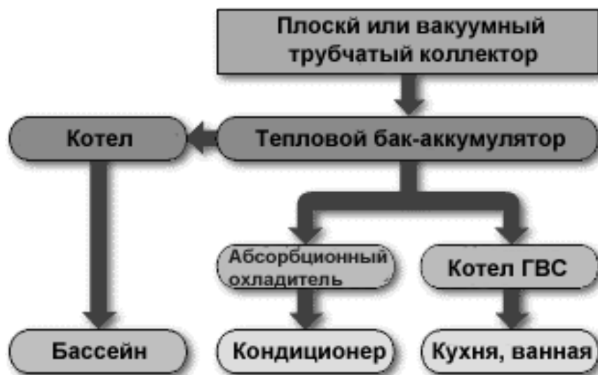
Рис. 2.5. Схема использования солнечных коллекторов
