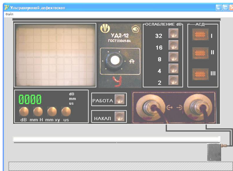
Рис. 2. Общий вид компьютерной модели ультразвукового дефектоскопа УД2-12
