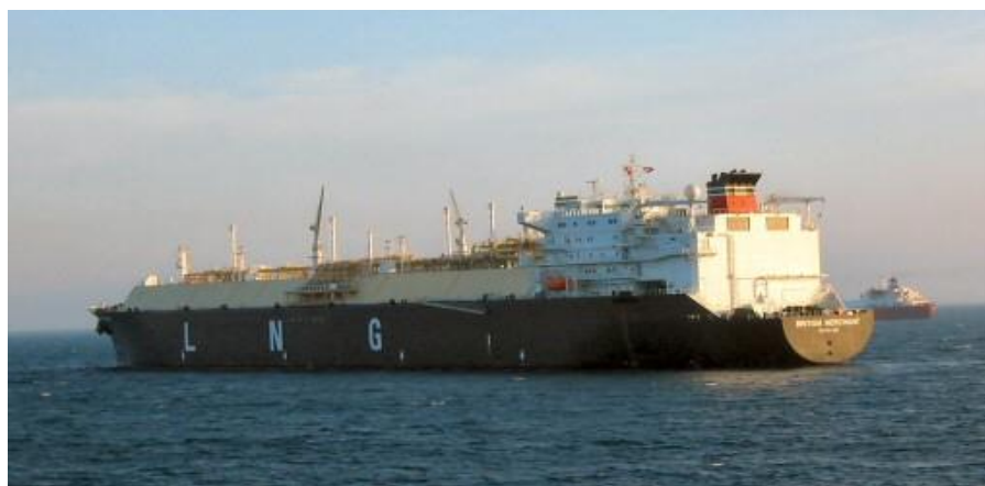
Рисунок 1.34 – Газовоз с танками мембранного типа
