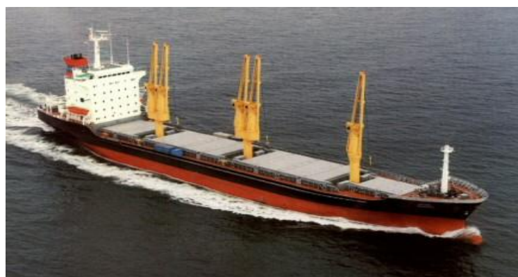
Рисунок 1.10 – Сухогрузное судно с кормовым расположением машинного отделения и надстройки
