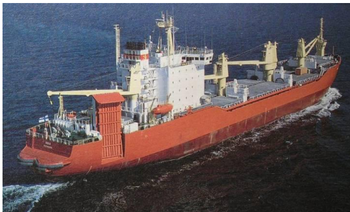
Рисунок 1.11 – Сухогрузный теплоход типа "Кола" дедвейтом 12800 т для перевозки генеральных грузов
