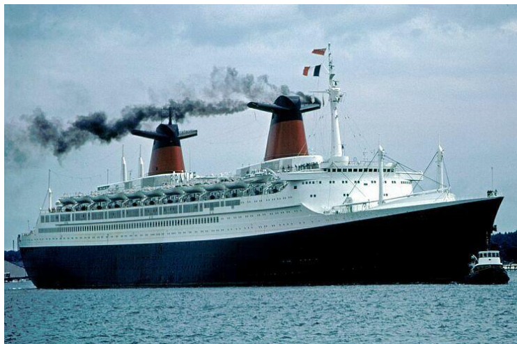
Рисунок 1.38 – Дымовые трубы на суперлайнере "France" ("Norway")
