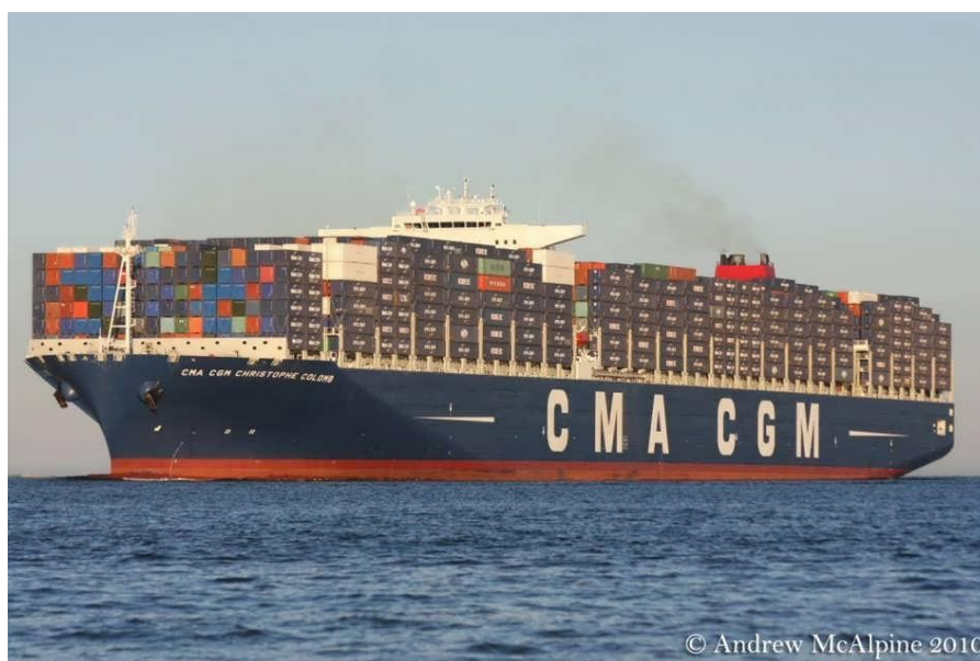
Рисунок 1.16 а – Контейнеровоз "СМА CGM Christophe Colomb" с промежуточным расположением машинного отделения и надстройки
