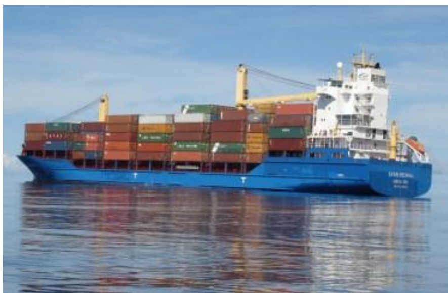
Рисунок 1.15– Контейнеровоз "Syms Peonia" с кормовым расположением машинного отделения и надстройки
