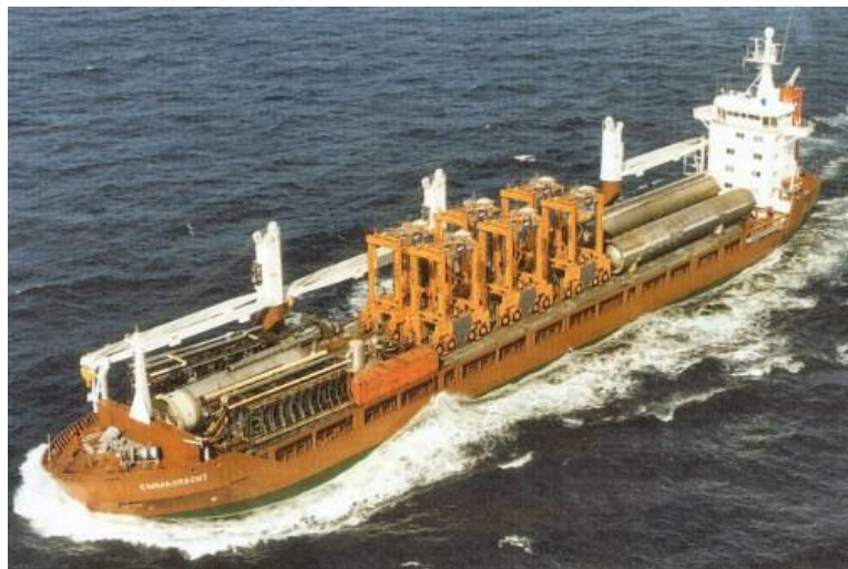
Рисунок 1.21 – Универсальное сухогрузное судно для перевозки тяжёловесных крупногабаритных грузов
