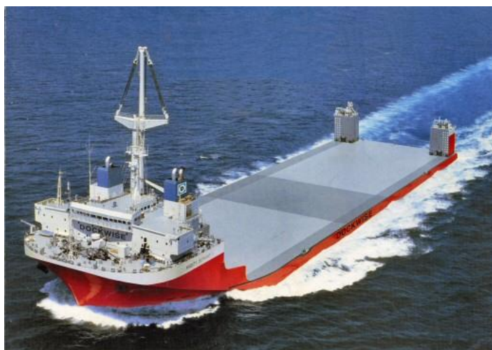
Рисунок 1.23 – Специализированное судно-док "Dockwise", для транспортировки тяжелых крупногабаритных грузов на палубе
