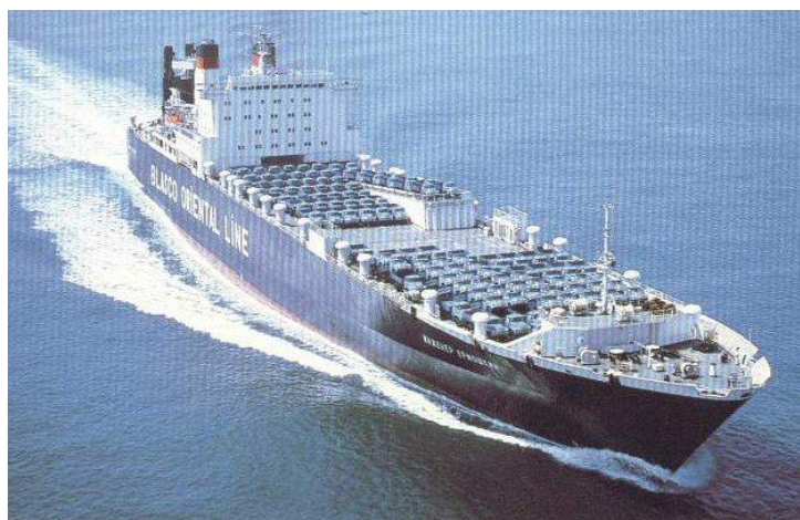
Рисунок 1.17 – Ролкер "Инженер Ермошкин" вместимостью 1305 контейнеров и 240 легковых автомобилей
