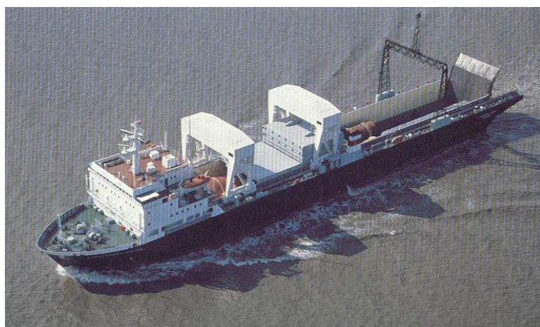
Рисунок 1.22 – Судно ро-флоу "Стахановец Котов" для перевозки крупногабаритных и тяжёловесных грузов
