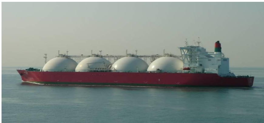
Рисунок 1.35 – Газовоз со сферическими вкладными цистернами
