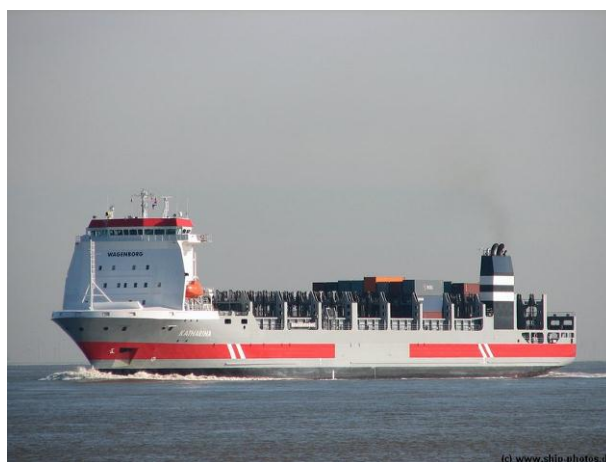
Рисунок 1.16 в –Контейнеровоз "Katarina" с носовым расположением надстройки
