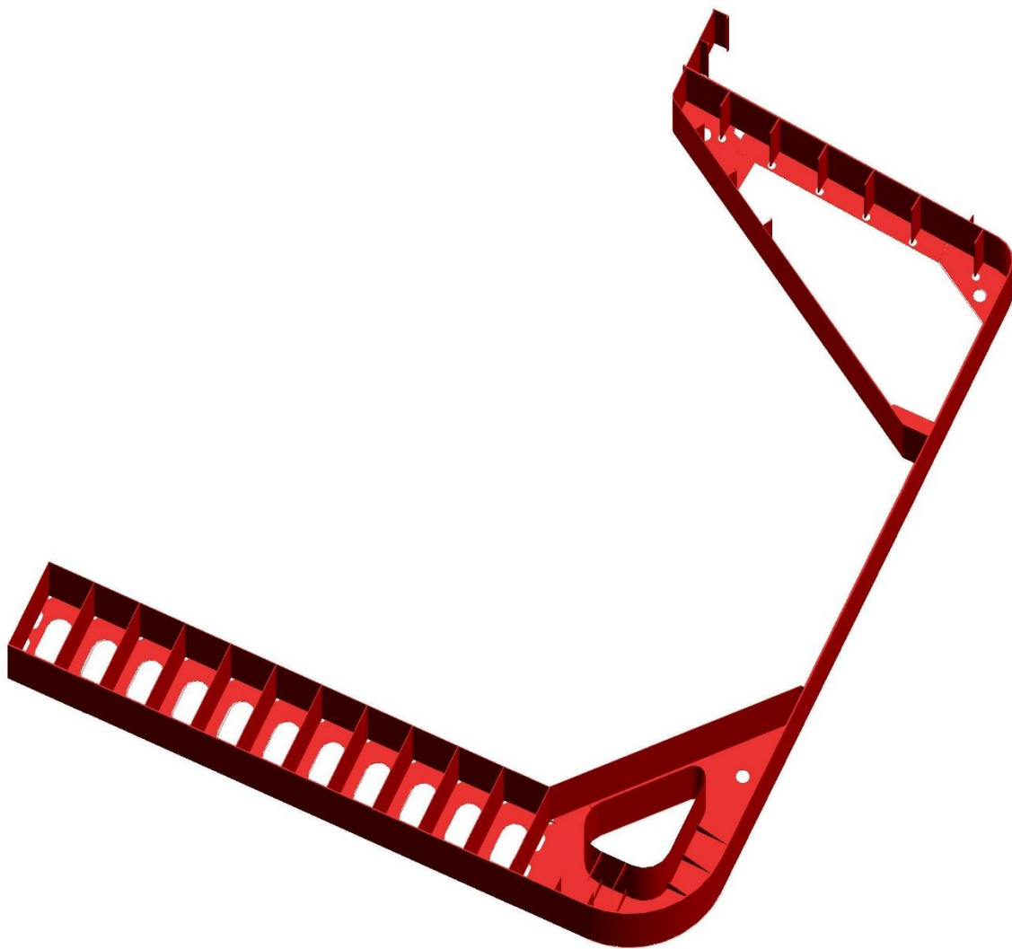
Рис. 9. Трехмерный мидель-шпангоут навалочного судна
