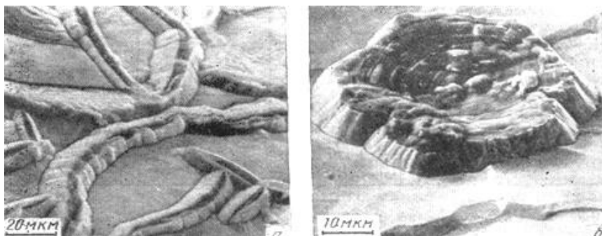
Рис. 45. Микроструктура графитовых включений а – пластинчатая; б – хлопьевидная
