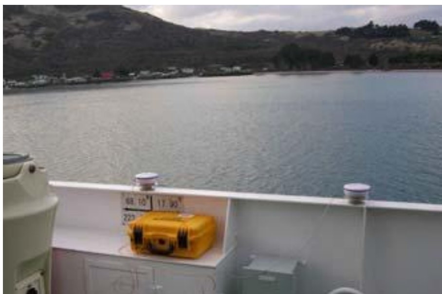
Рис. 5.3. Размещение кейса и двух антенн на крыле мостика
