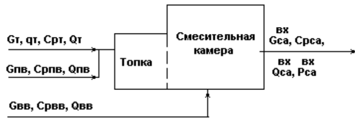
Рис. 2.28. Структурная схема топки и смесительной камеры
