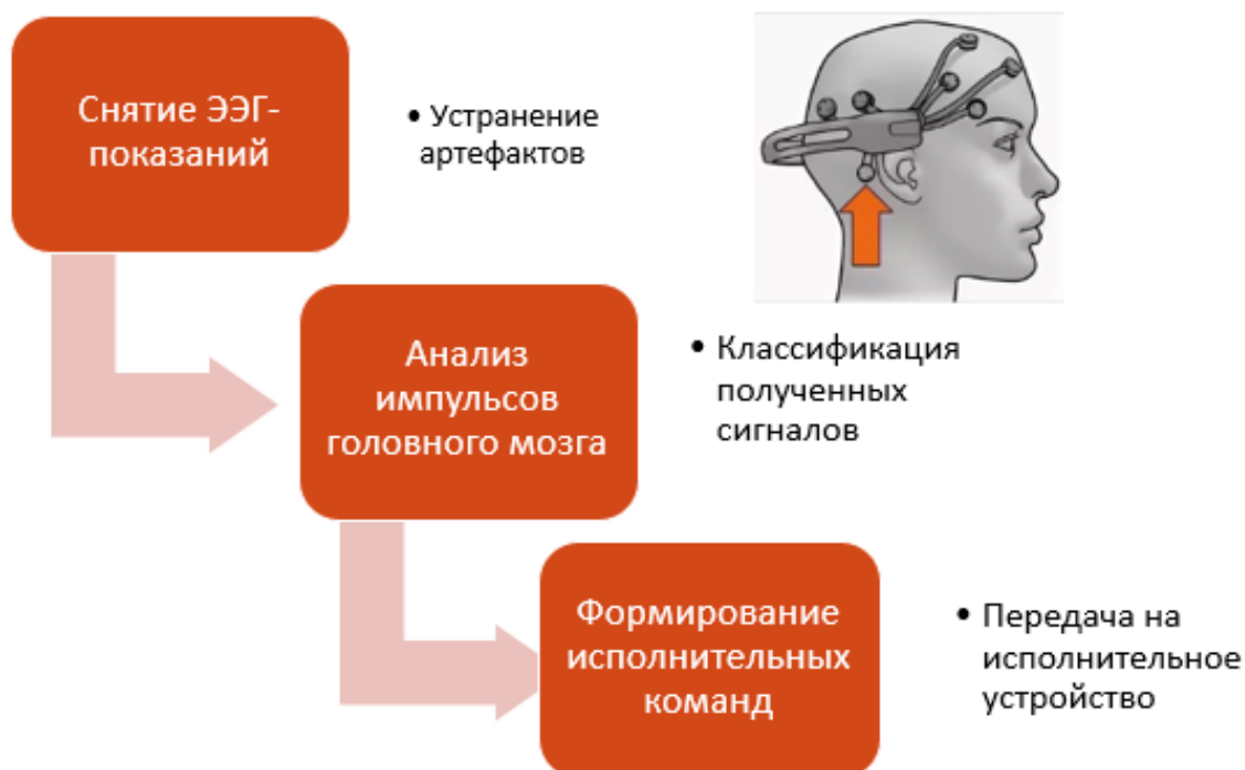
Рисунок 2 – Схема неинвазивного нейроинтерфейса
