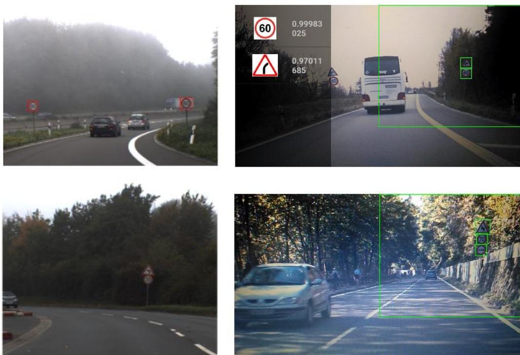
Рисунок 3 – Примеры успешного и неудачного распознавания дорожных знаков системой
