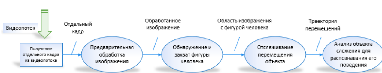
Рисунок 1 – Обобщенная схема работы системы анализа распределения потоков покупателей
